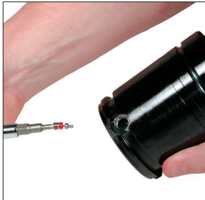
3S. 将新紧充气阀（90.260）或插入充气阀（90.265）装入阀口，直至其在阀座上紧密贴合。避免过度拧紧气阀。
