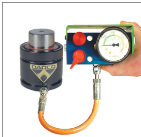
1L. 将所有氮气弹簧使用管连接回控制面板，确保所有连接都紧固，氮气弹簧的活塞杆伸出。
