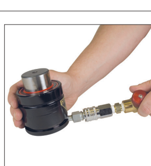
4. 缓慢打开充气软管末端的截止阀，使氮气弹簧达到所需充气压力。
