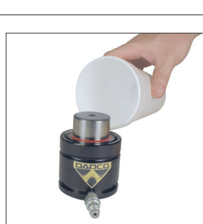
6. 使用矿物油或水检测活塞杆的周围及缸体底部的阀室周围的密封性。注意：若采用弹簧连管模式，则可使用DADCO压力分析仪（型号90.315.5）验证压力。且测试期间该必须保持原位。
