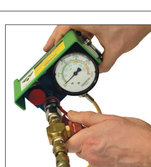
2L. 将充气组件（90.310.040）连接至控制面板上的快速断开充气接头。
