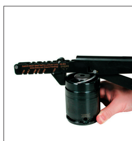
6. 使用DADCO C型卡环安装工具（型号90.352或90.352.10000）将C形卡环插入卡环槽中。确保C形卡环完全卡入卡环槽内。
