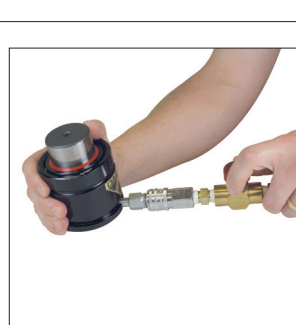
5. 当弹簧充至所需压力后，关闭软管截止阀和储罐截止阀。将充气组件从充气接头处拆卸。拆卸接头时，截止阀与充气阀之间残留的少量氮气将自动排出。
