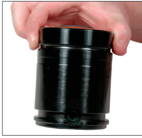
1L. 检查端口是否有沉积物或毛刺，并彻底清洁。检查端口接头，如有损坏迹象则予以更换。在接头的螺纹和密封件上涂抹润滑油。将维修接头装入氮气弹簧端口。
