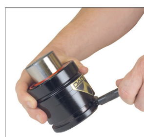
2. 要降低氮气弹簧的压力时，请使用DADCO排气工具（型号90.360.4）或DADCO压力分析仪（型号90.315.5）按压气阀。
