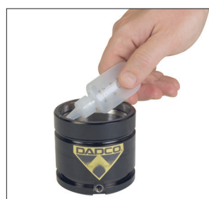
4. 用全部DADCO组装油润滑缸体内壁。
