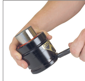
3S. 保持面部与手部远离端口，使用气阀排气工具（90.360.4）或端口维修工具（90.320.8）按压紧充气阀（90.260）或插入充气阀（90.265）。用布覆盖端口以吸收泄漏物。
