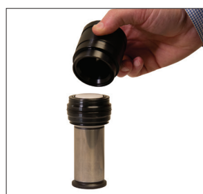
2. 将活塞套启动套件（90.335.x）中的组装推（90.331.x）放入活塞杆，将活塞套滑到组装推或活塞杆上，确保有“TOP”标记的挂钩端面向上。将活塞套启动套件（90.335.x）中的组装推（90.330.x）置于活塞套顶部。
