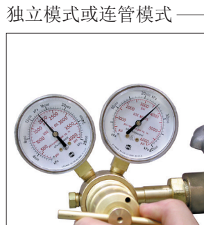
3. 打开充气罐的主阀门。在调节阀上设定所需充气压力。请勿超过150巴的最大充气压力。
