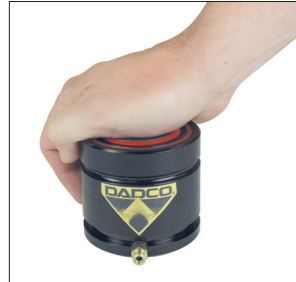
2L. 将活塞杆手动推下缸体内，确认所有压力已释放。若活塞杆无法完全缩回，释放残余压力。若仍未成功，请停止操作并联系DADCO。
