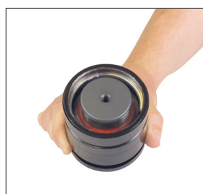
5. 活塞杆和活塞套放入在缸体的开口中。使用气阀排气工具（90.360.4）或端口维修工具（90.320.8）按压气阀释放压力。可使用组装推（90.330.x）将活塞杆和活塞套推入到缸体内。将活塞套的顶部定位于卡环槽下方。
