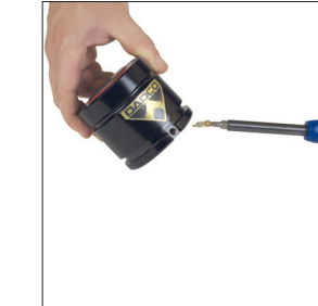
2S. 使用端口维修工具（90.320.8）按下紧充气阀（90.260）或插入充气阀（90.265）。
