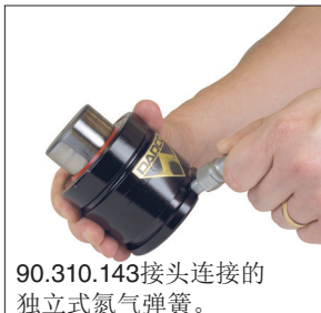
1S. 将快速断开充气接头（型号90.310.143或90.310.111）旋入氮气弹簧的端口。将充气组件的内螺纹端连接至充气接头。DADCO压力分析仪（90.315.5）亦可用于独立式氮气弹簧的充气、排气及压力检测。
