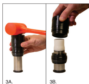
3A. 握住住活塞套，垂直轻敲组装推使活塞套顺着活塞杆向下推入，注意避免倾斜强行推入，以免损坏密封件。
