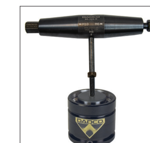
7. 选择合适的T型手柄的螺纹（M6、M8或M10），并物T型手柄（90.320.M）放入活塞杆端面的螺纹孔。向上拉动T型手柄，直至活塞套的顶部完全超过C形卡环。充气前，活塞杆必须在活塞套内完全固定住。活塞套的顶部应与缸体的端面齐平。确保活塞杆拉上来到正确行程长度。（按下气阀可使活塞杆完全拉上来。）
