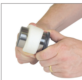
1. 用砂纸（600号）轻轻打磨活塞杆的表面。检查活塞套表面是否有划痕或凹痕。若杆体受损，必须更换。
