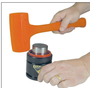
9. 安装新的防尘圈（90.246.U.x）。用软锤轻敲，直至防尘圈的顶部与缸体端面齐平。此时应能看到活塞杆的挂钩圈。
