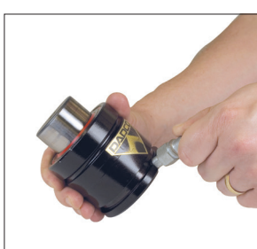
1. 为增加弹簧压力，将快速断开充气阀接头（型号90.310.143或90.310.111）旋入端口，将调节器设定至所需压力后进行充气。亦可使用DADCO压力分析仪（型号90.315.5）调节压力。
