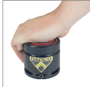
4S. 待氮气压力完全释放后，务必确认活塞杆可手动自由地压下缸体内。若无法压下，请再次尝试按压力阀门。若仍未成功，请停止操作并联系DADCO。
