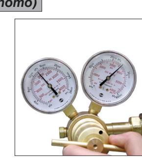
4. Ajuste la presión de carga deseada en el regulador.
