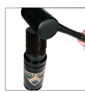
5. Coloque el vástago y cartucho dentro del resorte. Para liberar cualquier contrapresión, presione la válvula del cartucho. La tapa de ensamble (90.330.x) se puede utilizar para introducir el vástago y cartucho dentro del vaso.
