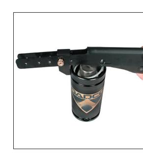
7. Inserte el anillo de retención tipo C (90.285.x) en la ranura del anillo de retención con una herramienta de instalación de anillo C de DADCO o herramientas de banco estándar. Asegúrese de que el anillo de retención C esté completamente asentado en la ranura del anillo de retención. Asegúrese de que el vástago esté extendido a su longitud de carrera adecuada. (Presione la válvula del cartucho para facilitar la extensión completa de el vástago).
