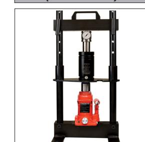
8S. Verifique la presión con una celda de carga de DADCO usando un banco de pruebas portátil (90.305.3) o una prensa mecánica.
