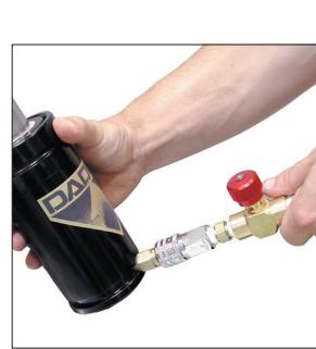
5. Lentamente abra la válvula de cierre en el extremo de la manguera de carga y permita que el resorte de nitrógeno alcance la presión de carga deseada. Después de cargar el resorte de gas a la presión deseada, CIERRE LA VÁLVULA DE CIERRE DE LA MANGUERA Y LA VÁLVULA DE CIERRE DEL TANQUE.
