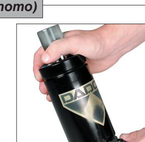
2S. Para disminuir la presión del resorte de nitrógeno presione el vástago de la válvula con la herramienta de drenado de la válvula (90.360.4) para drenarla y ajustar la presión.
