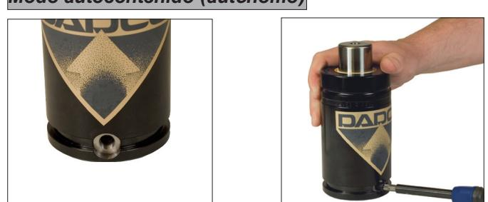
1. Generalmente no es necesario reemplazar la válvula. Si la válvula parece dañada, tiene fugas de presión o está atascada, proceda al paso 2. Si no es necesario reemplazar la válvula, proceda a "III. Extracción del anillo C".
