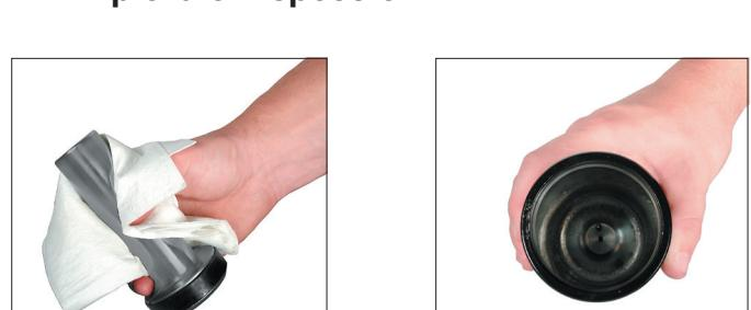
1. Pula ligeramente la superficie del vástago con una lija (grano 600). Inspeccione el acabado del vástago en busca de raspaduras o cualquier otro daño. Si el vástago está dañado, tendrá que reemplazarlo. Si existe, el anillo de seguridad del vástago deberá permanecer en su lugar.
