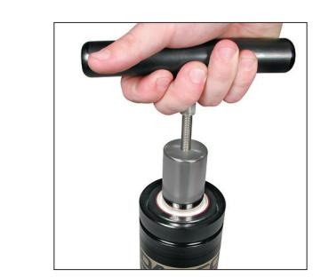
8. Enrosque la manija en T (90.320.M) en el extremo del vástago del pistón. Jala la manija T hacia arriba hasta que la parte superior del cartucho sobrepase el anillo C. El vástago debe asentarse completamente el cartucho (con la carcasa al ras del extremo del cilindro). Asegúrese de que el vástago esté extendido a su longitud de carrera adecuada. (Presione la válvula del cartucho para facilitar la extensión completa de el vástago).
