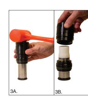
3A. Mientras sostiene el cartucho, golpee verticalmente la tapa del ensamble para empujar el cartucho hacia abajo por el vástago. Asegúrese de no forzar el cartucho inclinado durante el armado ya que la junta podría dañarse.
