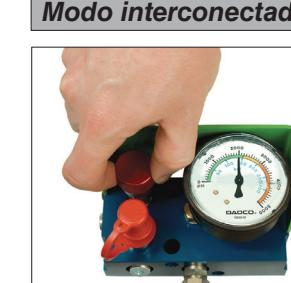
3L. Para aumentar la presión del sistema, coloque el regulador en el tanque de nitrógeno al nivel deseado y llene el sistema a través del panel de control. Para liberar la presión, abra la válvula de drenado en el panel de control.
