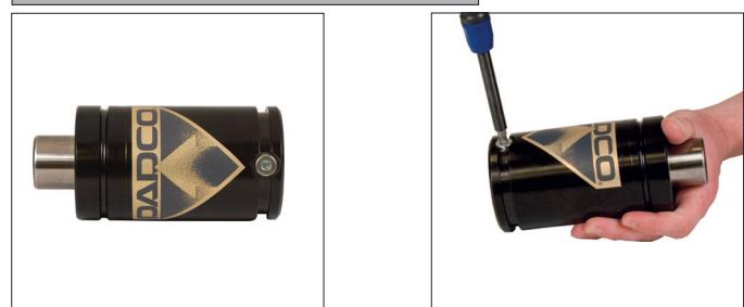
1. Al liberar la presión, por seguridad coloque el resorte de nitrógeno de manera horizontal con el puerto hacia arriba.
