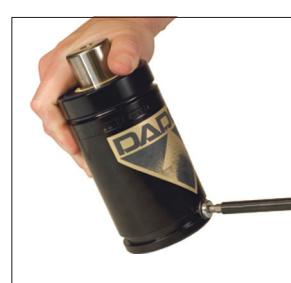
9S. Asegúrese de que la válvula del cartucho esté en su lugar y enrosque la tapa del puerto (90.505.110) de forma segura sobre la parte superior.
