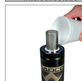
7. Verifique que no haya fugas en la parte superior del vaso alrededor de la varilla y en la base alrededor del compartimiento de la válvula usando aceite vegetal o agua.
