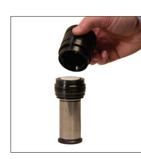
2. Enrosque el cono de montaje (90.331.x) del kit básico de cartucho (90.335.x) en el vástago. Deslice el cartucho sobre el vástago asegurándose de que el extremo limpiador marcado "TOP" esté hacia arriba. Coloque la tapa del cartucho (90.330.x) del kit básico de cartucho (90.335.x) sobre el cartucho.
