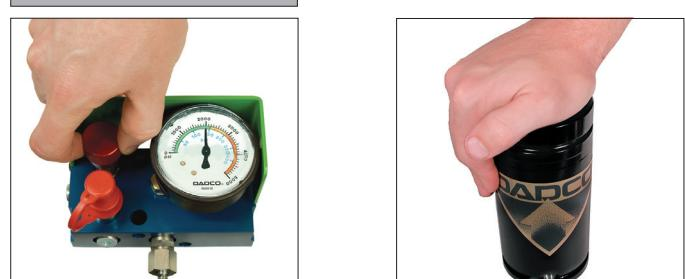
1. Abra la válvula de drenado en el panel de control para liberar la presión de nitrógeno.
