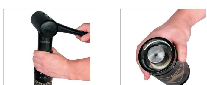
1. Coloque el resorte de nitrógeno en posición vertical. Asegúrese de que el vástago esté totalmente retraido dentro del vaso. Coloque una camisa de extracción (90.340.x) sobre el vástago. Golpee suavemente la camisa hasta que se afloje el guardapolvo (90.246. X). Retire la cubierta antipolvo y desecheela.
