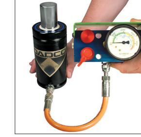
1L. Vuelva a interconectar todos los resortes de nitrógeno en el panel de control, asegurándose de que todas las conexiones estén apretadas y de que los vástagos del resorte de nitrógeno estén extendidas.
