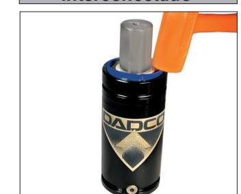
10. Instale el nuevo guardapolvo (90.246. X). Golpee con un mazo suave hasta que la parte superior del guardapolvo quede al ras con la parte superior del vaso. El limpiador debe estar visible.
