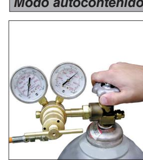
3. Abra la válvula principal en el tanque de nitrógeno.
