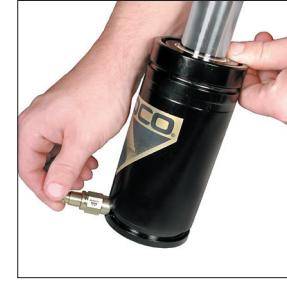
1S. Enrosque la boquilla de carga de desconexión rápida en el puerto del resorte de nitrógeno. Conecte el extremo hembra del ensamble de carga (90.310.040 o 90.310.045) a la boquilla de carga. El analizador de presión de DADCO (90.315.5) también se puede utilizar para cargar, descargar y medir la presión.
