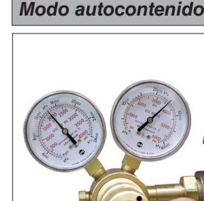
1S. Para aumentar la presión del resorte, enrosque la boquilla de carga de desconexión rápida (90.310.111) en el puerto, ajuste el regulador a la presión deseada y llene. También puede utilizar el analizador de presión de DADCO (90.315.5) para ajustar la presión.
