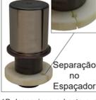
1B. Inspeccione a haste e o espaçador quanto a desgaste. Os modelos UX.6600 - UX.9600 com curso de até 125 mm têm um espaçador preto ou branco. Há uma divisão projetada no espaçador. Se houver mais rachaduras, trincas ou desgaste excessivo, o espaçador precisará ser substituído. Entre em contato com a DADCO para obter mais informações.
