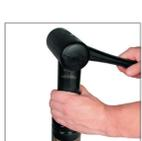
1. Coloque a mola a gás na posição vertical. Coloque o tubo de remoção (90.340.x), mais longo do que o curso, sobre a haste. Bata no tubo até que a tampa contra poeira (90.246.U.x) se solte. Remova a tampa contra poeira e descarte-a.
