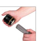
2. Quando o cartucho e a haste forem removidos do cilindro, deslize o kit para fora da haste e descarte. Guarde a haste para inspeção e reutilização. De acordo com o modelo que estiver reparando, prossiga para "V. Inspeção e Limpeza"; Etapa 1A, 1B ou 1C.
