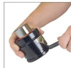
3S. Mantendo o rosto e as mãos afastados do orifício, use a Ferramenta de Exaustão (90.360.4) ou Ferramenta de Serviços (90.320.8) para pressionar o pino da Válvula Compacta (90.260) ou Válvula Cartucho (90.265). Cubra a entrada com um pano para absorver a descarga.
