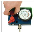
1L. Esgote o gás nitrogênio abrindo a válvula de exaustão no painel de controle.
