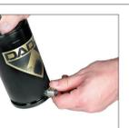
1. Para aumentar a pressão da mola, rosqueie a Válvula de Enchimento (90.310.143 ou 90.310.111) na entrada, ajuste o regulador para a pressão desejada e encha. O Analisador de Pressão da DADCO, (90.315.5), também pode ser usado para ajustar a pressão.
