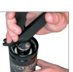
3. Remova o Anel de Retenção (90.285.x) usando uma Ferramenta de Remoção de Anel de Retenção (90.356 ou 90.355). Posicione a extremidade com gancho da ferramenta abaixo do anel de retenção. Para obter melhores resultados, posicione a ferramenta perto de uma das extremidades do anel de retenção.
