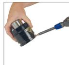
2S. Remova o bocal de proteção (90.505.110 ou 90.607.110). Guarde as peças para uso durante a remontagem.
