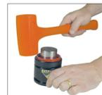
9. Instale a nova tampa contra sujeira (90.246.U.x). Bata com um martelo de borracha até que a parte superior da tampa fique nivelada com a parte superior do cilindro. A raspadeira da haste deve estar visível.
