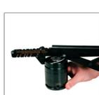
6. Insira o Anel de Retenção Tipo-C no entalhe interior do anel de retenção usando a Ferramenta de Instalação do Anel Tipo-C da DADCO (90.352 ou 90.352.10000). Certifique-se de que o anel de retenção esteja totalmente encaixado no entalhe do anel de retenção.
