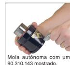
1S. Rosqueie a Válvula de Enchimento (90.310.143 ou 90.310.111) na entrada da mola a gás. Conecte a engate rápido do conjunto à válvula de enchimento. O Analisador de Pressão DADCO, (90.315.5), também pode ser usado para carregar, descarregar e medir a pressão em molas a gás autônomas.
