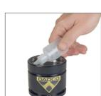
4. Lubrifique a parede interna do tubo com todo o óleo de montagem DADCO.
