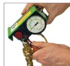
2L. Conecte o Conjunto Carregador (90.310.040) à válvula de enchimento no painel de controle.
