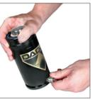
2L. Verifique se toda a pressão foi esgotada retirando manualmente a haste do pistão para dentro do cilindro. Se a haste não se retrair totalmente, libere a pressão restante. Se ainda assim não houver sucesso, pare e entre em contato com a DADCO.
