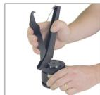
3. Remova o Anel de Retenção Tipo-C (90.285.x) usando uma Ferramenta de Remoção do Anel-C (90.356 ou 90.355). Posicione o gancho da ferramenta abaixo do anel de retenção. Para obter melhores resultados, posicione a ferramenta perto de uma das extremidades do anel tipo-C.
