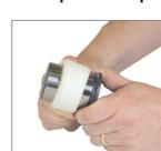
1. Faça um polimento leve da superfície da haste com um pano (grão 600). Inspeccione o acabamento da haste para ver se há arranhões ou amassos. Se a haste estiver danificada, deverá ser substituída.
