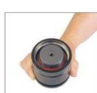
5. Coloque a haste e o cartucho no conjunto do tubo. Use a Válvula de Exaustão (90.360.4) ou a Ferramenta de Serviços (90.320.8) para pressionar o pino da válvula e liberar qualquer contra-pressão. A tampa de montagem (90.330.x) pode ser usada para inserir o conjunto de haste e kit no conjunto do cilindro. Posicione a parte superior do kit logo abaixo do entalhe do anel de retenção.
