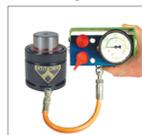
1L. Conduza todas os conjuntos de mangueira de volta ao painel de controle, certificando-se de que todas as conexões estejam apertadas e que as hastes das molas a gás estejam estendidas.
