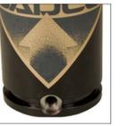
1S. Em geral, a válvula não precisa ser substituída. Somente se a válvula parecer danificada, estiver com vazamento de pressão ou travada, prossiga para a etapa 2S; caso contrário, deixe a válvula intacta e prossiga para "III. Remoção do Anel C".
