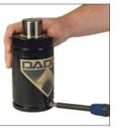
2S. Remova a Válvula Compacta (90.260) ou a Válvula Cartucho (90.265), desparafusando-a com a Ferramenta de Serviços (90.320.8).
