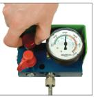
4S. Após a exaustão de toda a pressão do gás, certifique-se de que a haste do pistão se retraia livremente para dentro do cilindro manualmente. Caso contrário, tente pressionar a válvula novamente. Se ainda assim não tiver êxito, pare e entre em contato com a DADCO.
