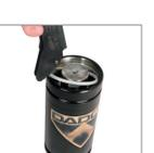
4. Quando a extremidade com o gancho da ferramenta estiver firmemente assentada abaixo do anel, comece a empurrá-la em direção à parte externa do cilindro da mola a gás. As alças na extremidade da haste. Puxe o conjunto inteiro para fora do tubo. O corpo do cilindro pode ser mantido em uma moeda (com garras macias) enquanto se puxa o conjunto para fora.
