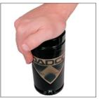
3S. Mantendo o rosto e as mãos afastados do orifício, use a Ferramenta para Exaustão da Válvula (90.360.4) ou a Ferramenta de Serviços (90.320.8) para pressionar o pino da Válvula Compacta (90.260) ou da Válvula Cartucho (90.265). Cubra a entrada com um pano para absorver a descarga.
