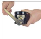
3L. Desrosqueie a conexão ou adaptador e limpe-a com um pano limpo. Prossiga para "II. Manutenção da Entrada" Modo Interligado etapa 1L.
