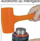
9. Instale a nova tampa contra poeira (90.246.U.x). Bata com um martelo de torçãoa até que a parte superior da tampa de poeira fique nivelada com a parte superior do cilindro. O limpador da haste deve estar visível.
