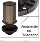
1A. Inspeccione a haste e o espaçador quanto a desgaste. Os modelos UX.0800 - UX.4600 com cursos de até 125 mm têm um espaçador preto ou branco. Há uma divisão projetada no espaçador. Se houver mais rachaduras, trincas ou desgaste excessivo, o espaçador precisará ser substituído. Entre em contato com a DADCO para obter mais informações.
