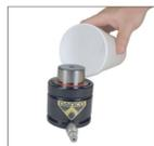
6. Verifique se há vazamentos na parte superior do cilindro, ao redor da haste, e na base, ao redor do compartimento da válvula, usando óleo mineral ou água para testar se há vazamentos. **ATENÇÃO:** se a mola estiver no modo interligado, um analisador de pressão DADCO (90.315.5) poderá ser usado para verificar a pressão e deverá permanecer no local durante o teste.
