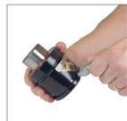
1. Para aumentar a pressão da mola a gás, rosqueie a Válvula de Enchimento (90.310.143 ou 90.310.111) na entrada, ajuste o regulador para a pressão desejada e encha. O Analisador de Pressão da DADCO, (90.315.5), também pode ser usado para ajustar a pressão.
