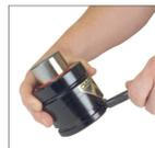
2. Para reduzir a pressão da mola a gás, pressione a haste da válvula usando uma Ferramenta de Exaustão DADCO (90.360.4) ou um Analisador de Pressão DADCO (90.315.5).
