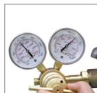
3. Abra a válvula principal no tanque de nitrogênio. Ajuste a pressão de carga desejada no regulador. Não exceda a pressão máxima de carregamento de 150 bar (2175 psi).
