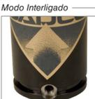
1L. Verifique se há depósitos ou rebarbas na entrada e limpe-a completamente. Inspeccione a conexão ou adaptador de entrada e substitua-a se ela apresentar sinais de danos. Lubrifique as roscas e as vedações da conexão e rosqueie a conexão de serviço na entrada da mola a gás.
