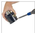
8S. Reinstale com segurança o bocal de proteção (90.505.110 ou 90.607.110).
