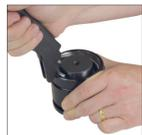
4. Quando a extremidade com gancho da ferramenta estiver firmemente assentada abaixo do anel de retenção, comece a empurrá-la em direção à parte externa do cilindro da mola a gás. As alças se fecharão naturalmente e o anel será extraído quando você concluir esse movimento. Para obter uma explicação detalhada sobre a remoção do anel de retenção, consulte o boletim B15127A.
