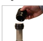
2. Para os tamanhos aplicáveis, rosqueie o Cone de Montagem (90.331.x) do Kit Inicial de Cartucho (90.335.x) na haste. Deslize o conjunto do cartucho sobre o cone de montagem e a haste, certificando-se de que a extremidade do limpador marcada como "TOP" esteja voltada para cima. Coloque a tampa de montagem (90.330.x) do kit (90.335.x) na parte superior do conjunto do cartucho.
