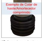
1C. Inspeccione a haste e o colar/amortecedor da haste quanto a desgaste. Para os modelos UX.6600 - UX.9600 com cursos de 150 mm ou mais, o colar/amortecedor é preto e se parece com uma série de laços. Se houver rachaduras, fissuras ou desgaste excessivo, o colar precisa ser substituído. Para verificar a condição, meça a altura do colar da haste/amortecedor e consulte a tabela para obter a medida A. Se a altura estiver fora da tolerância, entre em contato com a DADCO para reparo ou substituição.
