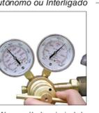
3. Abra a válvula principal da garrafa de nitrogênio. Defina a pressão de carga desejada no regulador. Não exceda a pressão máxima de carga de 150 bar (2175 psi).
