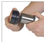
2. Quando o kit e a haste forem removidos, o conjunto do tubo, deslize o kit para fora da haste e descarte. Guarde a haste para inspeção e reutilização.
