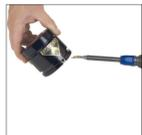
2S. Remova a Válvula Compacta (90.260) ou a Válvula Cartucho (90.265), desparafusando-a com a Ferramenta de Serviços (90.320.8).
