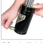
1S. Rosqueie a Válvula de Enchimento (90.310.143 ou 90.310.111) na entrada da mola a gás. Conecte a engate rápido do conjunto carregador à válvula de enchimento. O Analisador de Pressão DADCO, (90.315.5), também pode ser usado para carregar, descarregar e medir a pressão em molas a gás autônomas.
