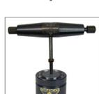
1. Para remover a Haste e Kit, selecione a ferramenta de serviço adequada da extremidade da haste (M6, M8 ou M10) e rosqueie a Sacador-T (90.320.M) na extremidade da haste. Puxe o conjunto inteiro para fora do cilindro. O corpo do cilindro pode ser mantido em uma morsa (com garra macias) enquanto se puxa o conjunto para fora.
