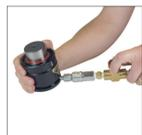
5. Depois que a mola tiver sido carregada até a pressão desejada, FECHÉ A VÁLVULA DE ENCHIMENTO DO CONJUNTO CARREGADOR E A VÁLVULA PRINCIPAL DO TANQUE. Desconecte o conjunto da válvula de enchimento. Uma pequena quantidade de nitrogênio presa entre o engate rápido e a válvula de enchimento soltará ao desconectar a conexão.
