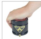
2L. Verifique se toda a pressão foi aliviada retraindo manualmente a haste do pistão para dentro do cilindro. Se a haste não se retrair totalmente, libere a pressão restante. Se ainda assim não houver sucesso, pare e entre em contato com a DADCO.
