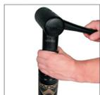
1. Coloque el resorte de vástago en posición vertical. Coloque una camisa de extracción (90.340.x) sobre el vástago, que sea más larga que la carrera. Golpee suavemente la camisa debajo del anillo en C. Para obtener los mejores resultados, coloque la herramienta cerca de alguno de los extremos del anillo C.
