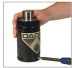
2S. Retire la válvula compacta (90.260) o la válvula del cartucho (90.265) usando la herramienta de servicio al puerto (90.320.8).
