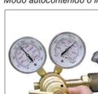
4. Abra lentamente la válvula de cierre en el extremo de la manguera de carga y permita que el resorte de nitrógeno alcance la presión de carga deseada.
