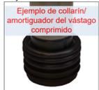
1C. Revise el collarín/amortiguador del vástago comprimido. Ejemplo de collarín/amortiguador del vástago comprimido. Si solo está dañada la banda de desgaste, se puede reemplazar. Comuníquese con DADCO para obtener una pieza de repuesto.
