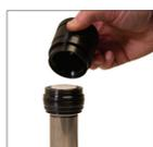
2. Enrosque el cono de montaje (90.337.x) del kit básico de cartucho (90.335.x) en el vástago. Deslice el cartucho sobre el vástago asegurándose de que el extremo limpiador marcado "TOP" esté hacia arriba. Coloque la tapa del ensamblaje de cartucho (90.330.x) del kit básico de cartucho (90.335.x) sobre el ensamblaje de cartucho.
