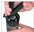
3. Retire el anillo de retención estivo C (90.285.x) utilizando una herramienta de extracción de anillo C (90.356 o 90.355). Coloque el extremo de gancho de la herramienta debajo del anillo en C. Para obtener los mejores resultados, coloque la herramienta cerca de alguno de los extremos del anillo C.
