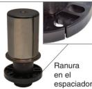
1A. Revise el vástago y el espaciador para detectar desgaste. Los modelos UX.0800 - UX.4600 con longitudes de carrera de hasta 125 mm tienen un espaciador negro o blanco. Hay una ranura diseñada en el espaciador. Si hay ranuras, rajaduras o desgaste excesivo adicionales, será necesario reemplazar el espaciador. Póngase en contacto con DADCO para obtener más información.
