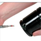
3S. Enrosque una nueva válvula compacta (90.260) o una válvula de cartucho (90.265) en el puerto hasta que encaje perfectamente. Evite apretar demasiado la válvula.
