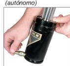
1S. Enrosque la boquilla de carga de desconexión rápida de los resortes de nitrógeno en el puerto del resorte de nitrógeno. Conecte el extremo hembra del ensamblaje de carga a la boquilla de carga. El analizador de presión de DADCO (90.315.5), también se puede utilizar para cargar, descargar y medir la presión en resortes de nitrógeno autocontenidos.
