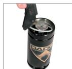
4. Una vez retirado el cartucho y el vástago del vaso, deslice el cartucho hacia afuera y deseche el cartucho viejo. Guarde el vástago para reutilizarlo. Dependiendo del modelo que esté reparando, proceda a "V. Inspección y limpieza" o "VI. Reemplazo de cartuchos".
