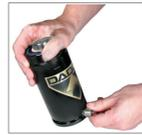
3L. Desenrosque el adaptador de servicio y límpielo con un paño limpio. Continúe con el paso 1L del modo interconectado "II. Mantenimiento del puerto."
