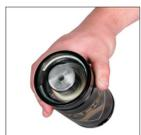
2. Vuelva a colocar la camisa de extracción de DADCO y continúe dando golpes hasta que el ensamblaje de cartucho y vástago quede ligeramente por debajo de la ranura del anillo de retención.
