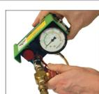
3. Abra la válvula principal en el tanque de nitrógeno. Ajuste la presión de carga deseada en el regulador. No exceda la presión de carga máxima de 150 bar (2175 psi).
