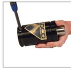
2S. Retire el tornillo protector. (90.505.110 o 90.607.110). Guarde las piezas para usarlas durante el armado.
