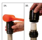
3A. Mientras sostiene el cartucho, golpee verticalmente la tapa del ensamblaje hacia abajo por el vástago. Asegúrese de no forzar el cartucho inclinado durante el armado ya que la junta podría dañarse.
