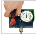
1L. Abra la válvula de drenado en el panel de control para liberar la presión de nitrógeno.
