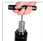
1. Para quitar el ensamblaje de vástago y cartucho, seleccione la rosca de servicio para el extremo del vástago adecuada (M6, M8 o M10) y enrosque el mango en T (90.320.M) en el extremo del vástago. Saque todo el ensamblaje del vaso. El cuerpo del resorte se puede sujetar en un tornillo de banco (con mordazas suaves) mientras se extrae el ensamblaje.
