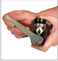
3. Desenroscar a conexão e limpar com um pedaço de pano limpo. Proceder para "II. Manutenção da Entrada" Modo de Fluxo Aberto passo 1.
