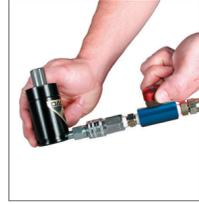
4. Lentamente abra a válvula de fechamento na extremidade da mangueira de carregamento e deixe que a mola a gás alcance sua carga de pressão desejada. Também pode utilizar o 90.310.044.
