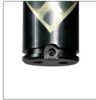
1. Verificar a entrada livre de depósitos ou rebarbas e limpe-a completamente. Inspeccionar o adaptador de entrada e substitua caso apareça sinais de danos. Lubrifique as roscas e as vedações no adaptador e rosqueie na entrada da Mola a Gás.
