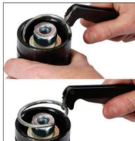
4. Uma vez que o gancho da ferramenta está firmemente posicionado abaixo do C-Ring, comece a empurrá-lo para fora do Corpo do Cilindro. As alças fecharão naturalmente, e o C-Ring será extraído enquanto você completa este movimento. Para uma explicação detalhada sobre a remoção do C-Ring, ver boletim #B13113C.
