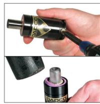
8. Instale o novo Anel de Proteção Contra Sujeira, (90.246.x.x). Bater com um martelo macio até que a extremidade do Anel de Proteção Contra Sujeira se alinhe com a extremidade do Corpo do Cilindro. A raspadeira do pistão deverá estar visível.
