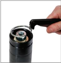
3. Remover o C-Ring (Anel de Retenção) (90.285.x.x), usando a Ferramenta de Remoção do C-Ring (90.355). Posicione a ponta da ferramenta com o gancho abaixo do C-Ring. Para melhores resultados posicione a ferramenta bem próximo as extremidades do C-Ring. (Utilize a Ferramenta para Serviços para soltar os Anéis de Retenção C-ring encontrados em cursos de 13 mm ou modelos menores).
