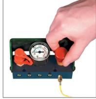
1. Esgotar a mola a gás abrindo a Válvula de Exaustão no painel de controle.
