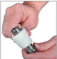
1. Polir levemente a superfície da haste com um pano para lustrar (600 grit). Verificar se o acabamento da haste contém arranhões ou batidas. Caso a haste tenha se danificado, ela deverá ser trocada.
