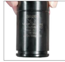
1. Escolher o kit de reparo apropriado. O kit de reparo necessário está gravado a laser na parte de trás do Corpo do Cilindro.
