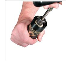
7. Rosqueie o Sacador-T, (90.320.M), na extremidade do pistão. Puxe para cima com o Sacador-T até o topo do conjunto da haste ter ultrapassado totalmente o C-ring. O pistão deve assentar no conjunto da haste totalmente antes de carregar. O conjunto da haste deve estar nivelado com a extremidade do cilindro. Certifique-se de que o pistão esteja estendido para o seu comprimento de curso adequado. (Pressione a agulha da válvula para facilitar a completa extensão do pistão.)
