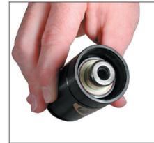
5. Coloque a haste do pistão com o conjunto dentro do Corpo do Cilindro. Pressione a agulha da válvula para liberar qualquer contrapressão. Posicione o topo do conjunto logo abaixo do entalhe do anel de retenção. O formato do conjunto da haste foi elaborado para segurá-la nesta posição. **NÃO forçar o conjunto da haste ainda mais para dentro do cilindro.**
