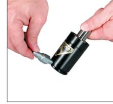
1. Rosqueie a ponta M6 da Válvula de Carregamento com Engate Rápido, (90.310.143), na entrada da mola a gás. Conecte a ponta fêmea do conjunto carregador à válvula de enchimento. O DADCO Analisador de Pressão, (90.315.5), também pode ser utilizado para carregamento, descarregamento e medição da pressão.
