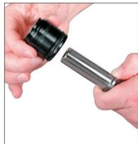
2. Uma vez que o conjunto da haste foi removido do corpo do cilindro, deslizar o conjunto da haste para fora e descartar. Guardar o haste para inspeção e reuso.
