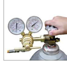
2. Abrir a válvula principal no tanque de nitrogênio.
