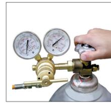
6. Após todas as molas a gás do sistema terem sido carregadas até a pressão desejada, FECHAR A VÁLVULA DE FECHAMENTO DO CONJUNTO CARREGADOR E A VÁLVULA DE FECHAMENTO DO TANQUE.
