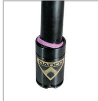
1. Posicione a Mola a Gás para cima. Posicione um Tubo de Remoção (90.340.x), maior do que o curso sobre a haste. Certifique-se de usar um Tubo de Remoção apropriado para o cilindro. Bater levemente o tubo até que o Anel de Proteção (90.246.x.x) se solte. Remova o Anel de Proteção e jogue fora.
