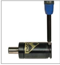
3. Mantendo o rosto e mãos livres do orifício, utilize a Ferramenta para Exaustão da Válvula, (90.360.4), ou a Ferramenta para Serviços, (90.320.8), para pressionar a agulha da válvula 90.260. Cobrir o orifício com um pano para absorver a descarga.
