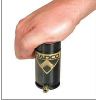
2. Verificar se toda a pressão do gás esgotou, recolhendo a haste no tubo manualmente. Caso a haste não recolha totalmente, esgote a pressão restante. Se continuar sem êxito, parar a operação e entrar em contato com o seu representante de serviço DADCO.
