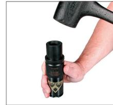
6. Insira o Anel de Retenção C-Ring no entalhe do anel retentor usando a DADCO Ferramenta de Instalação do C-Ring, (90.351.x ou 90.352). Certifique-se de que o Anel Retentor esteja totalmente encaixado no entalhe do anel retentor. Para uma explicação detalhada de como usar a Ferramenta de Instalação do C-Ring 90.352, veja o boletim B01101E.
