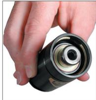
2. Reposicione o DADCO Tubo de Remoção e somente continue batendo levemente até que o conjunto da haste esteja um pouco abaixo do entalhe do anel de retenção. O diâmetro interno do Corpo do Cilindro foi desenhado para parar o cartucho nesta posição. **NÃO forçar o retentor mais para baixo do entalhe do anel dentro do Corpo do Cilindro.**
