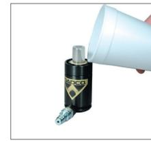
7. Verifique se há vazamentos no topo do cilindro, em volta do pistão e na base em torno do compartimento da válvula, usando óleo mineral ou água. Verifique a pressão com a Célula de Pressão DADCO, utilizando uma Bancada de Teste Portátil DADCO, (90.305.3). **ATENÇÃO:** Caso a mola a gás seja fluxo aberto, a válvula de enchimento (90.310.143) deverá permanecer no local durante o teste.
