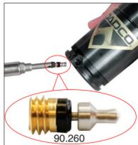
4. Parafusar uma nova Válvula Compacta, (90.260), na entrada até que ela se encaixe perfeitamente. Evitar apertar demais a válvula.
