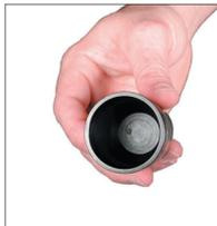
2. Verificar se Corpo do Cilindro apresenta algum dano, especialmente ao redor da abertura do Corpo do Cilindro. Polir suavemente qualquer qualquer dano na borda do Corpo do Cilindro para evitar danos nos selos durante o processo de remontagem. Se o dano no Corpo do Cilindro for muito sério, deverá então ser substituído. Lavar, limpar e secar por dentro completamente.
