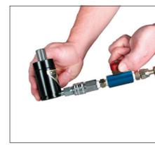
5. Gire a válvula de carregamento até que ela se alinhe com a posição Fechada e Ventilada localizada no botão preto inferior. Se estiver usando o conjunto carregador padrão (90.310.040), a pequena quantidade de nitrogênio presa entre a válvula do cilindro e a válvula de enchimento escapará quando você desconectar o engate.
