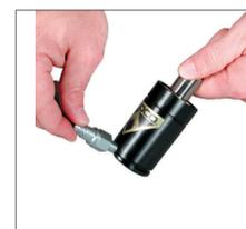
1. Para aumentar a pressão da mola a gás, rosqueie a Válvula de Enchimento com Engate Rápido, (90.310.143), na entrada, ajuste o regulador à pressão desejada e carregue. O 90.315.5 pode também ser utilizado para ajustar a pressão.
