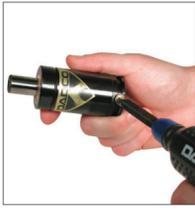
2. Remover o Bujão, (90.607.110), localizado na base da Mola a Gás. Guarde as peças para utilizar durante a remontagem.
