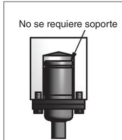
Los montajes con brida soportan la carga completa (RM, NF, FA, RF, TB). No hace falta respaldo.
