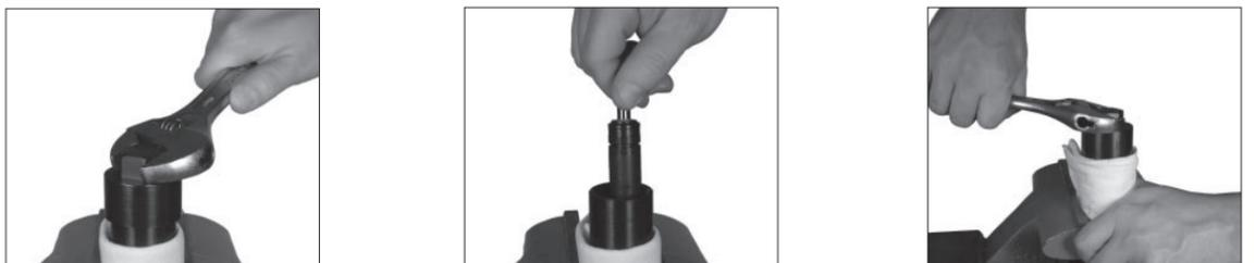
1. Envuelva el cuerpo del cilindro SLN.090/SLN.180 en un paño suave. Sujete el SLN.090 boca abajo en un torno, de tal manera que el cilindro esté seguro. Retire la cabeza trasera usando la herramienta para retirar la cabeza trasera, con una llave o con el Kit para retirar cabezas.
