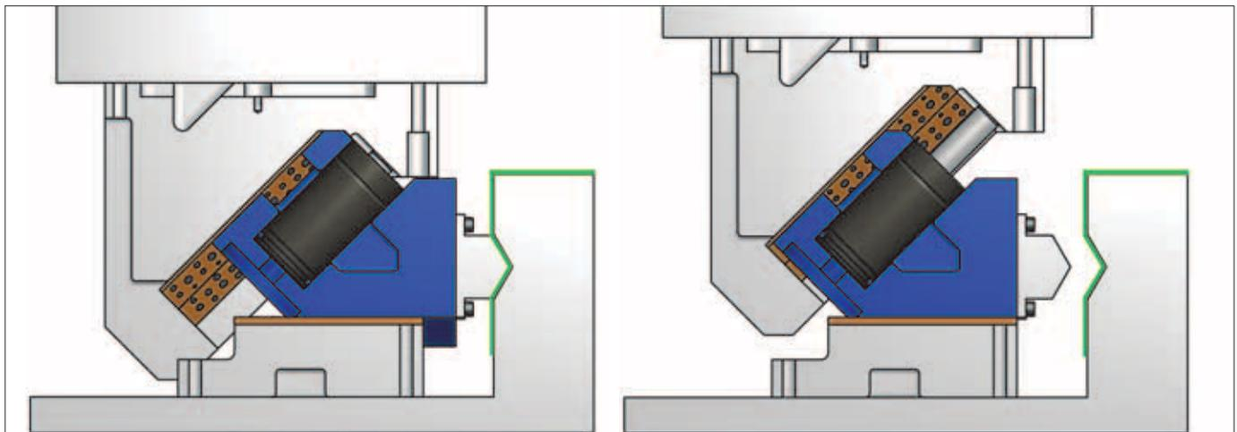
A FCL.755 mola a gás nitrogênio almofadada é instalada em um carrinho que faz parte de uma ferramenta ligada ao carrinho de cunha, ilustrado acima. Molas a gás série FCL são bem adequadas para aplicações com carrinho impulsionados pela prensa. A almofada embutida fornece uma força desacelerada no percurso de retorno e uma redução no aumento da pressão durante o seu funcionamento geral.
