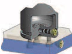
DADCO Gasdruckfedern in einem SMS-i® System verwenden einen Anschluss mit Dichtring am Boden der Feder. Die Befestigung auf der Platte erfolgt über die Gewinde am Boden der Gasdruckfeder.
