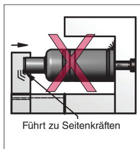
Kolbenstange nicht führen. Keine Befestigung am Boden bei ungeführten, offenen Anwendungen.
