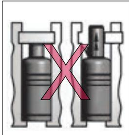
突然释放将导致氮气弹簧泄气 (漏气)。
