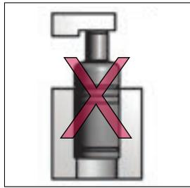
在任何情况下、氮气弹簧的底面必须安置在平面上。不正确的槽孔可能导致氮气弹簧的结构损坏或使用寿命缩短。
