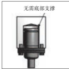
所有安装正确的法兰 (RM, NF, FA, RF, TB) 都能支持该负载。无需底部支撑。
